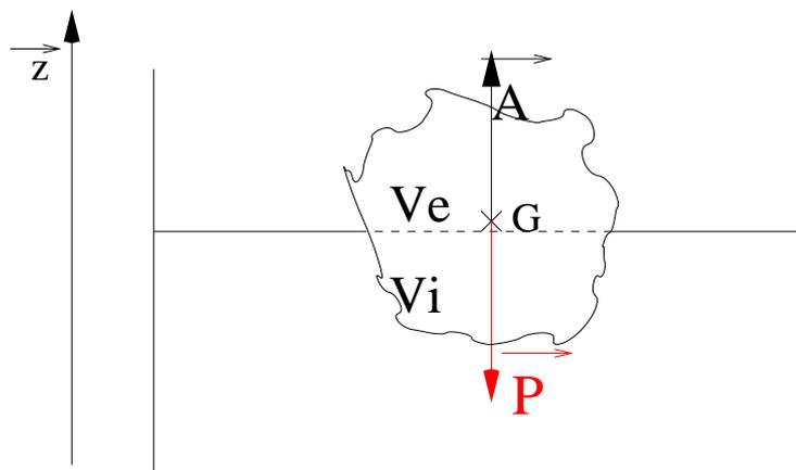
Figure 1: Illustration du principe d'Archimède : au repos, un corps plongé dans un liquide est soumis à son propre poids et à la poussée d'Archimède  $\vec{A} = \rho_{liq} V_i g \vec{u}_z$ , où  $V_i$  est le volume immergé de l'objet (égal au volume de liquide déplacé) et  $\rho_{liq}$  la masse volumique du liquide.
