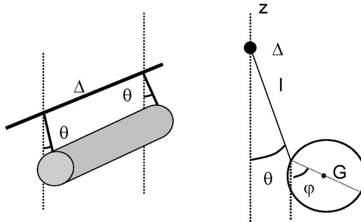
FIG. 1 – Représentation schématique du cylindre creux ( $S$ ) de rayon  $r$ . Les fils de longueur  $l$  sont inextensibles et fixés à l'axe  $\Delta$ . On suppose que ces fils forment le même angle  $\theta$  avec la verticale. La figure de droite est une vue de la face avant de  $S$ . Le point  $G$  est la projection du centre de gravité de  $S$  sur cette face. L'angle  $\phi$  repère la rotation de  $S$  sur lui même.
