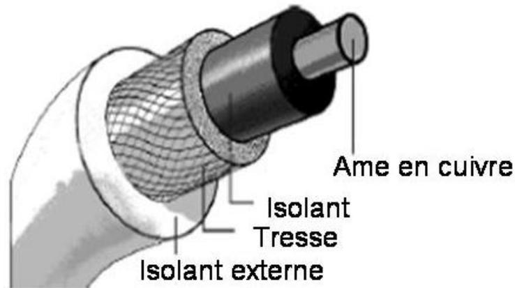
FIG. 2 – Représentation schématique d'un câble coaxial. Du centre vers l'extérieur on a successivement : une âme centrale en cuivre, un premier isolant (si possible non-magnétique), une tresse cylindrique servant de cage de Faraday, un second isolant.
