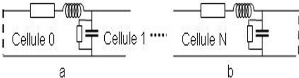
FIG. 4 – Extrémité gauche a), et droite b) de la chaîne ouverte constituée de  $N$  cellules. En pointillés, réalisation d'un court circuit.
